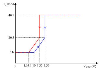
Figure 7. Io vs. V<sub>SDNG</sub>
