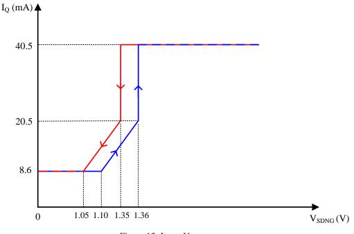
Figure 13. I<sub>Q</sub> vs. V<sub>SDNG</sub>
