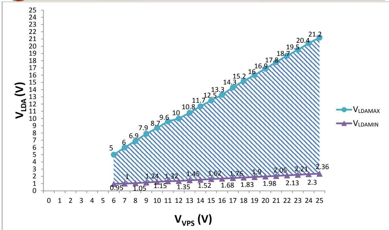
Figure 12. V<sub>VPS</sub> vs. V<sub>LDA</sub>
