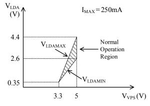
Figure 6. V<sub>VPS</sub> & V<sub>LDA</sub>
