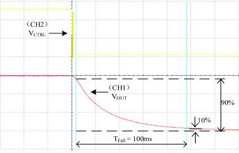
CH1: 2200V/Div CH2: 2V/Div M: 20ms/Div  $V_{CTRL}$ : 0.25V  $\sim$  5V  $V_{OUT}$ : 330V  $\sim$  6600V
