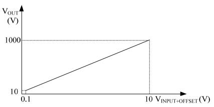
Figure 2. V<sub>INPUT+OFFSET</sub> vs. V<sub>OUT</sub>
