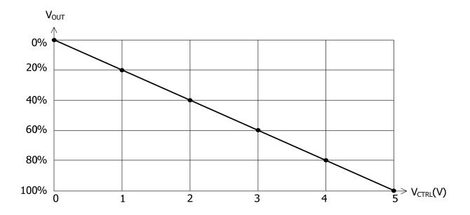
Figure 7. V<sub>CTRL</sub> vs. V<sub>VOUT</sub>
