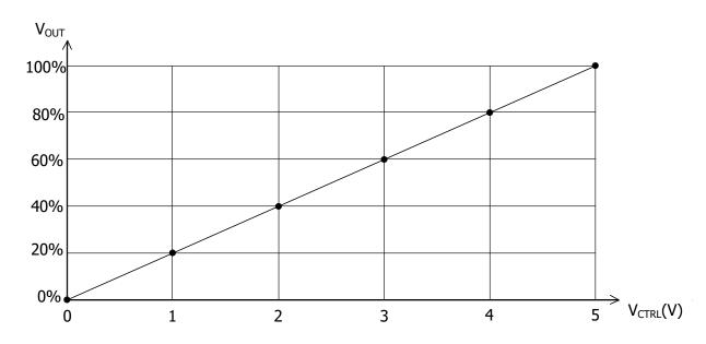
Figure 7. V<sub>CTRL</sub> vs. V<sub>VOUT</sub>
