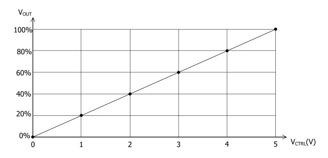
Figure 7. V<sub>CTRL</sub> vs. V<sub>VOUT</sub>
