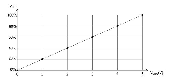
Figure 7. V<sub>CTRL</sub> vs. V<sub>VOUT</sub>
