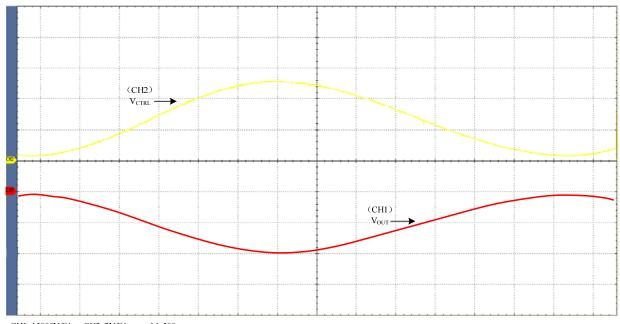
CH1: 15000V/Div CH2: 2V/Div  $V_{CTRL} \hbox{:}~ 0.25 V \sim 5 V \qquad V_{OUT} \hbox{:}~ -1400 V \sim -30000 V$
