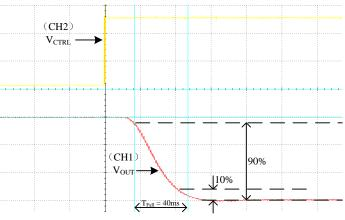
$V_{CTRL}$ : 0.25V~5V  $V_{OUT}$ : -1250V ~ - 25000V
