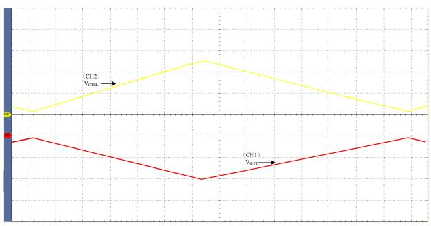
CH1: 12500V/Div CH2: 2V/Div M: 500m  $V_{CTRL}$ : 0.25V ~ 5V  $V_{OUT}$ : -1250V ~ -25000V
