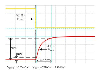
(CH1) V<sub>OUT</sub> 90% V<sub>CTRL</sub>: 0.25V~5V V<sub>OUT</sub>: -750V ~ -15000V
