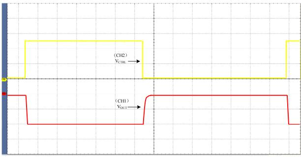
CH1: 7500V/Div CH2: 2V/Div M: 500m: V<sub>CTRL</sub>: 0.25V ~ 5V V<sub>OUT</sub>: -750V ~ -15000V
