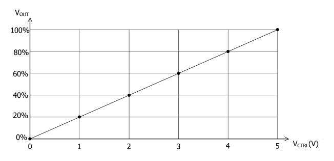
Figure 7. V<sub>CTRL</sub> vs. V<sub>VOUT</sub>
