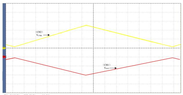
CH1: 5000V/Div CH2: 2V/Div M: 500m  $V_{CTRL}$ : 0.25V ~ 5V  $V_{OUT}$ : - 500V ~ - 10000V
