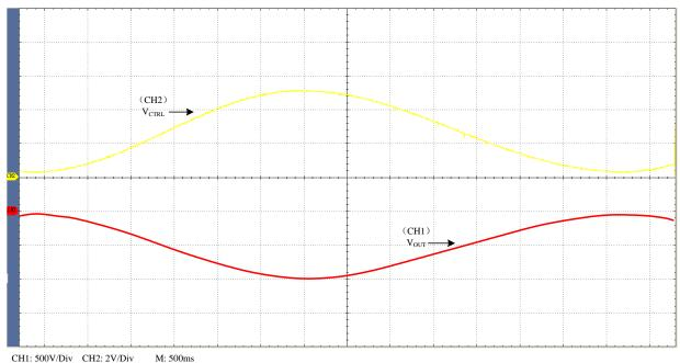
$V_{\text{CTRL}}$ : 0.25V ~ 5V  $V_{\text{OUT}}$ : - 500V ~ - 10000V
