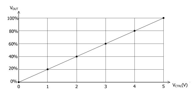
Figure 7. V<sub>CTRL</sub> vs. V<sub>VOUT</sub>
