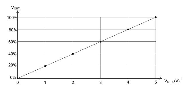
Figure 7. V<sub>CTRL</sub> vs. V<sub>VOUT</sub>
