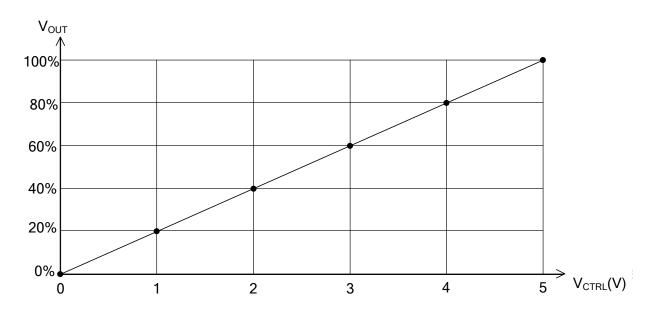
Figure 7. V<sub>CTRL</sub> vs. V<sub>VOUT</sub>
