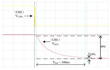
V<sub>CTRL</sub>: 0.25V ~ 5V V<sub>OUT</sub>: 1250V ~ 25000V
