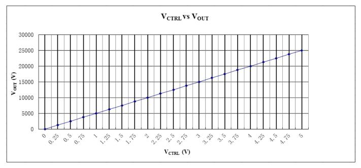
Figure 2. V<sub>CTRL</sub> vs. V<sub>OUT</sub>
