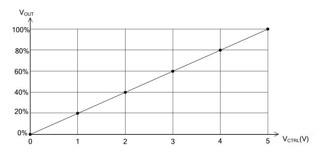
Figure 7. V<sub>CTRL</sub> vs. V<sub>VOUT</sub>
