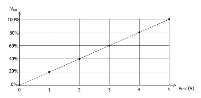
Figure 7. V<sub>CTRL</sub> vs. V<sub>VOUT</sub>
