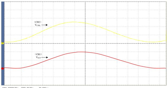
CH1: 5000V/Div CH2: 2V/Div M: 500ms V<sub>CTRL</sub>: 0.25V ~ 5V V<sub>OUT</sub>: 500V ~ 10000V
