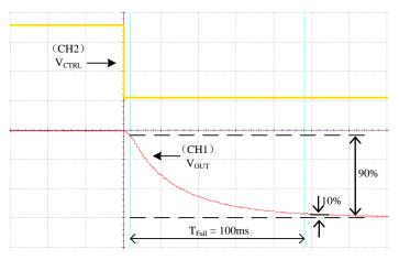
$V_{CTRL} : 0.25 V \sim 5 V \qquad V_{OUT} : 40 V \sim 10000 V$
