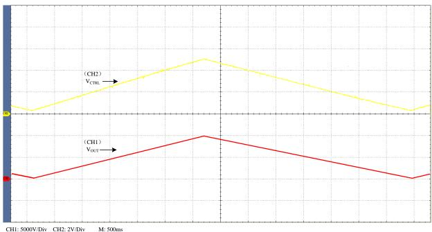
CH1: 5000V/Div CH2: 2V/Div M: 500m V<sub>CTRL</sub>: 0.25V ~ 5V V<sub>OUT</sub>: 500V ~ 10000V
