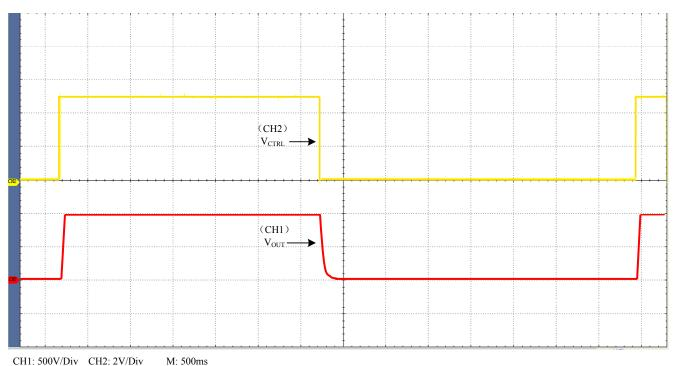
$V_{CTRL}$ : 0.25V ~ 5V V<sub>OUT</sub>: 40V ~ 1000V
