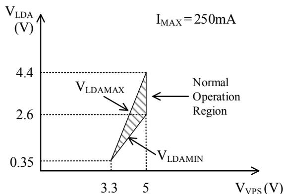
Figure 6.  $V_{VPS}$  &  $V_{LDA}$
