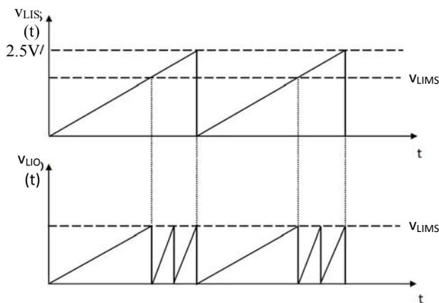
Figure 14.  $V_{LIS}$  &  $V_{LIO}$
